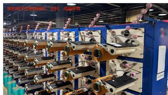
新的电子控制绕线机，低耗，成品率高
